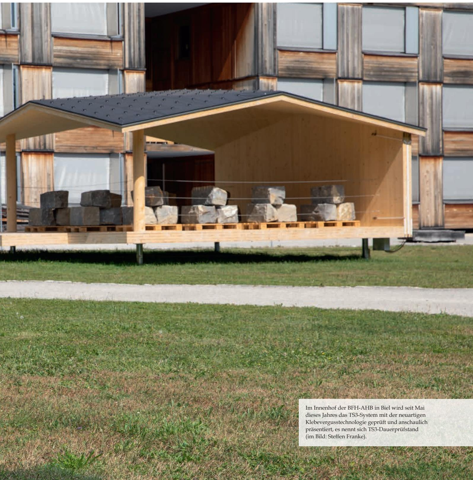
Im Innenhof der BFH-AHB in Biel wird seit Mai dieses Jahres das TS3-System mit der neuartigen Klebeverglasstechnologie geprüft und anschaulich präsentiert, es nennt sich TS3-Dauerprüfstand (im Bild: Steffen Franke).
