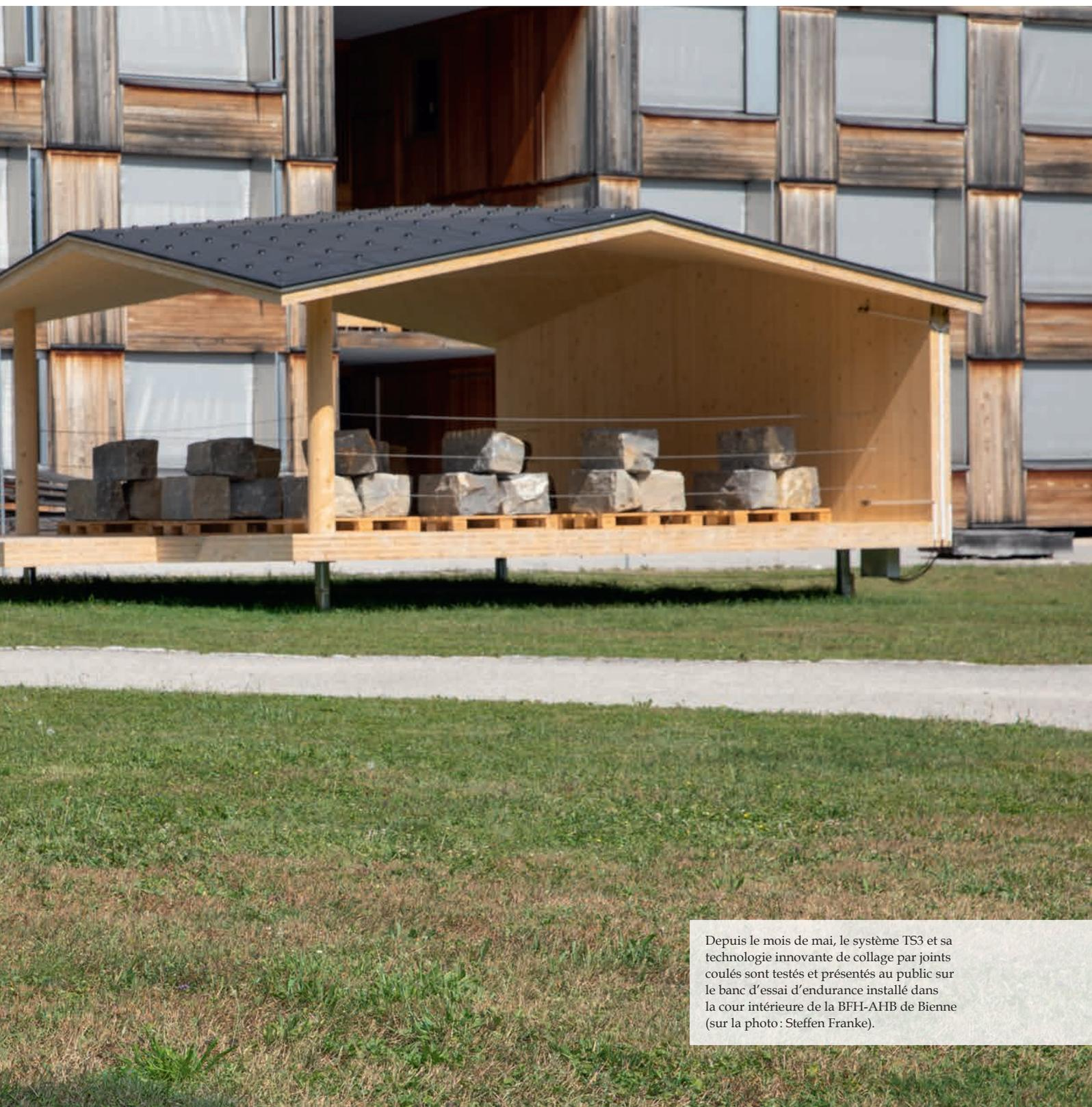
Depuis le mois de mai, le système TS3 et sa technologie innovante de collage par joints coulés sont testés et présentés au public sur le banc d'essai d'endurance installé dans la cour intérieure de la BFH-AHB de Bienne (sur la photo : Steffen Franke).
